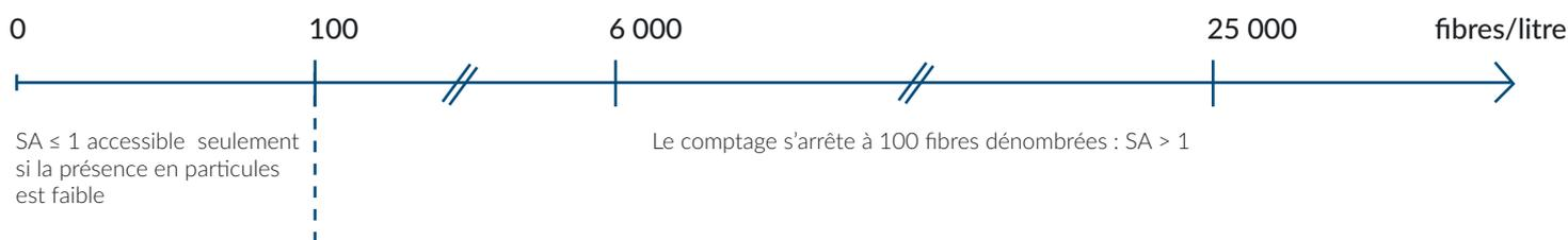
Dans le cas où l'obscurcissement est important, le laboratoire est amené à réitérer la préparation du filtre, en utilisant une fraction plus petite. Cela augmente la SA, mais permet de rendre un résultat qui peut être utilisé par le demandeur dans le cadre de son évaluation des risques.
